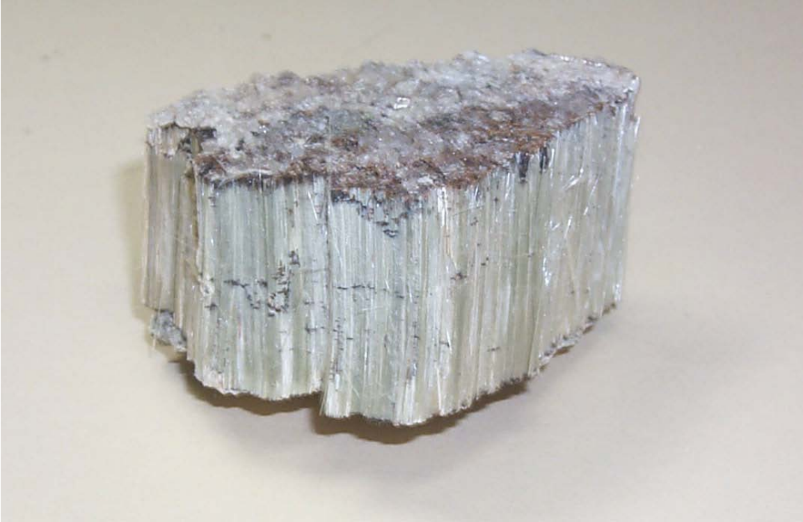
Slika 3. Najčešće korišteni azbestni materijal u Hrvatskoj je bio krizotil, ali on je najmanje opasan od svih 6 azbestnih materijala i dugo se raspravljalo o opravdanosti njegove potpune zabrane za korištenje.
